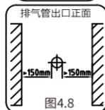
(5) 排烟管出口必须设置在室外。热水器使用时，排气管出口可能有冷凝水滴落，安装时应注意不要影响他人。排气管出口距周围物体的间距如图 4.9 所示。
